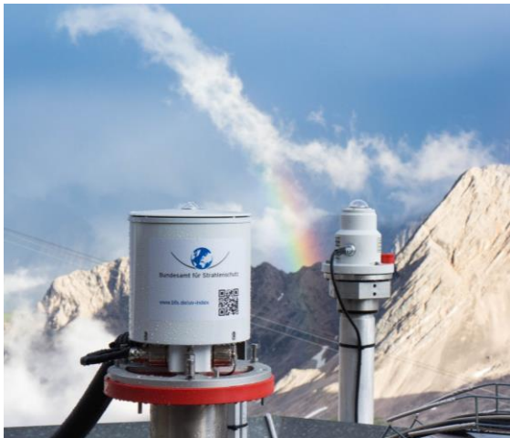
Abb.1: Messgeräte zur Erfassung der solaren UV-Strahlung: Breitbandradiometer der LMU (rechts) und Dioden-Array-Spektralradiometer des BfS (links)
