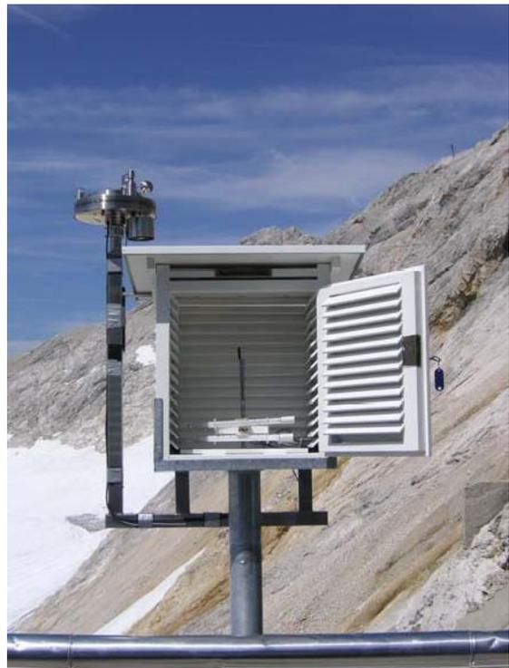
*Abb.1: Automatische Wetterstation und konventionelle Wetterhütte am Schneefernerhaus zur vergleichenden Messung der täglichen Extremtemperaturen*
