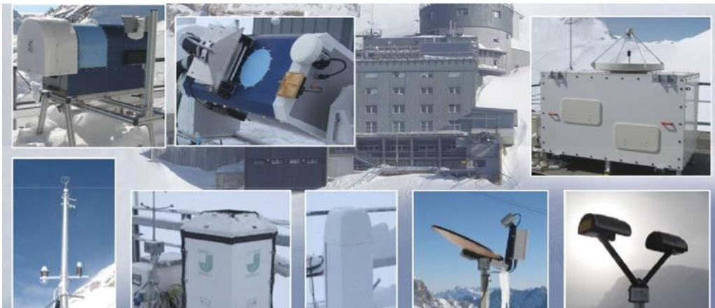
Abb.1: Messgeräte an der UFS im Winter 2008/2009. Oben von links nach rechts: Mikrowellenprofiler HATPRO, 90/150 GHz Radiometer DPR, 36 GHz Wolkenradar MIRA36. Unten von links nach rechts: 10 m Messmast, 2-dimensionales Video Distrometer, Wolkenhöhenmesser, Mikro-Regen-Radar, Parsivel Distrometer.
