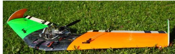
Abb.1: Rumpf und Sensorträger des am Institut für Geographie der Universität Augsburg entwickelten unbemannten Luftfahrtsystems.
