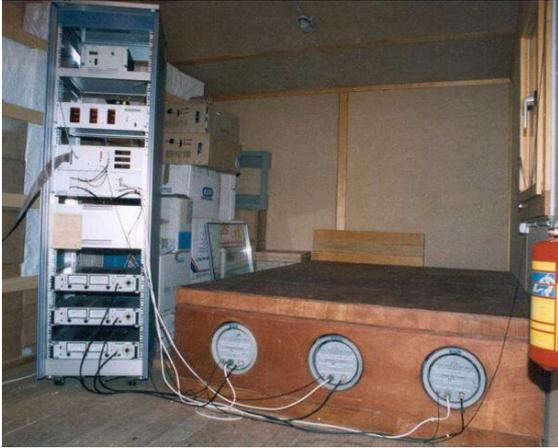
Abb. 1.: Typ 3-NM64 Neutronenmonitor auf der Jungfrau-
