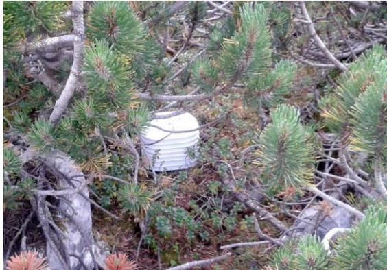
Abb. 2-3: Datalogger zur Aufzeichnung geländeklimatischer Parameter innerhalb eines Latschenbestandes sowie Darstellung der aufgezeichneten Daten während des Messzeitraums 2015-2016. Foto: Korch
