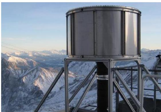
Abb. 1: Antenne des Wolkenradar MIRA-36 an der UFS auf dem Dach des Wechselnutzerlabors.
