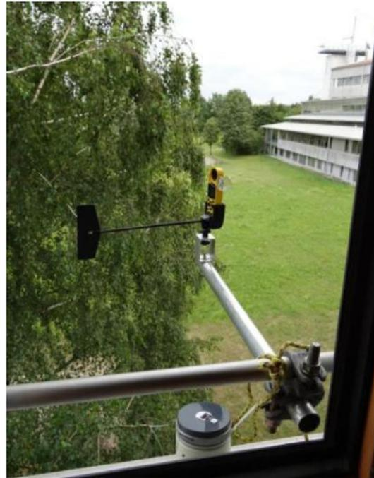
Abb.2: Portabler volumetrischer Partikelsammler vor Bürofenster mit Kestrel Weather Tracker an der TUM
