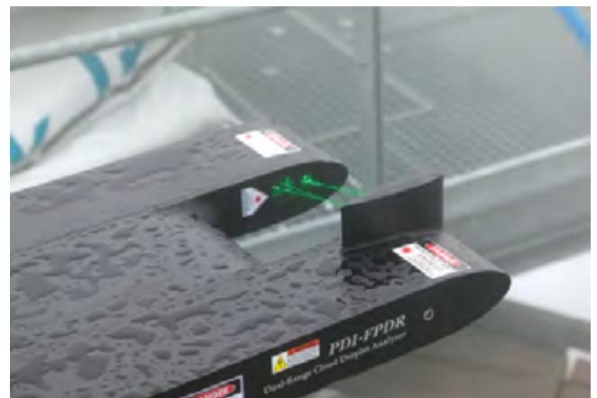
PDI-Probe während einer Messung: Dabei können Tröpfchen bis zu 0,5 \mu\text{m} aufgenommen werden.
