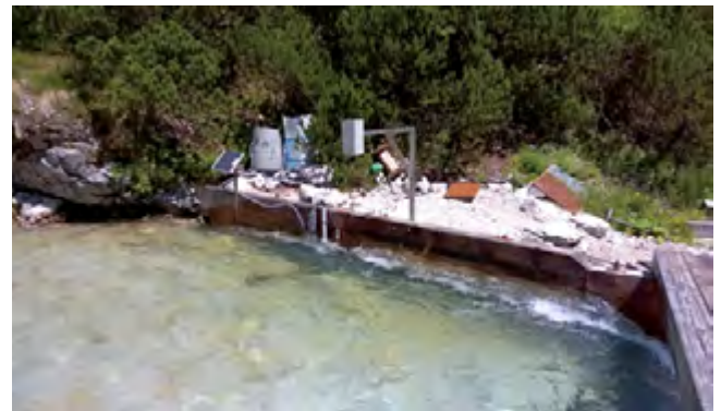
Pegelmessstelle an der Partnach kurz unterhalb des Partnachsprungs
