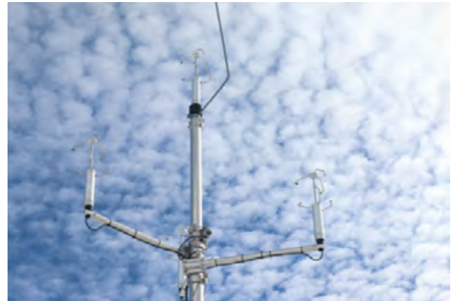
Mast mit Anemometer: Es misst die Windgeschwindigkeit und die virtuelle Temperatur mit 10 Hz.
