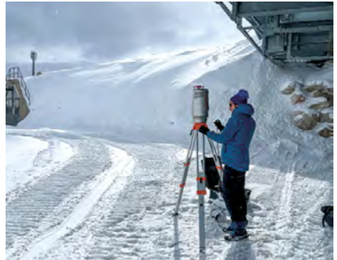
Laserscanning zur Erfassung von Schneeoberflächen mit einem LiDAR während der Messkampagne im April 2024
