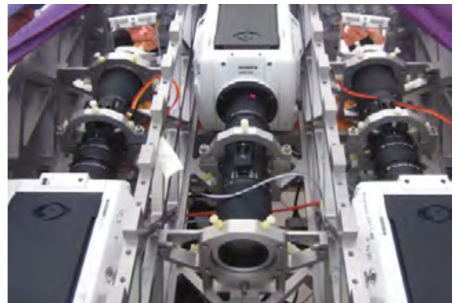
Montage von Hochgeschwindigkeitskameras des Max-Planck Instituts für Dynamik und Selbstorganisation. Das System kann einzelne Tröpfchen in Wolken filmen, um ihre Bewegung und Dynamik zu ergründen.
